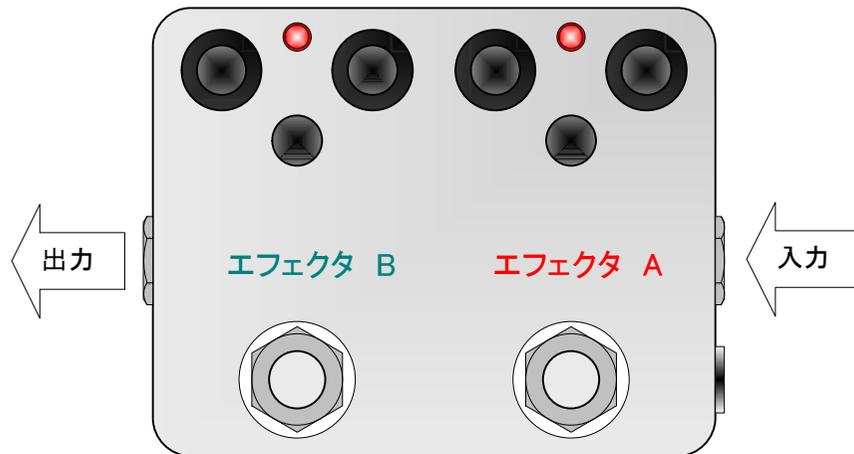
図のように、向かって右側(エフェクタA)から、左側(エフェクタB)の流れで、組み立てます。
